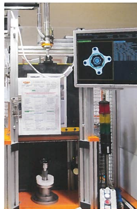
„Elektronische Augen“ prüfen Kundenanschlussmaße auf 100-%ige Genauigkeit und garantieren perfekte Qualität.
