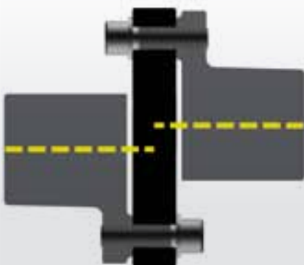
Radial- bzw. Mittenversatz: In geringem Maß, abhängig von der Baugröße und Steifigkeit der jeweiligen Gelenkscheibe.
