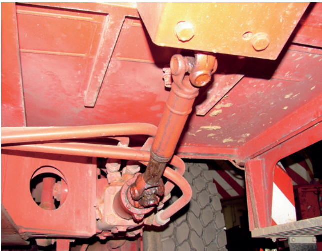
Bild 2. Nach sorgfältiger Prüfung des Lastenheftes konnte die in der Bildmitte dargestellte Lenkwelle eines Fahrzeugs für leichtes Gelände wartungsfrei ausgeführt werden
